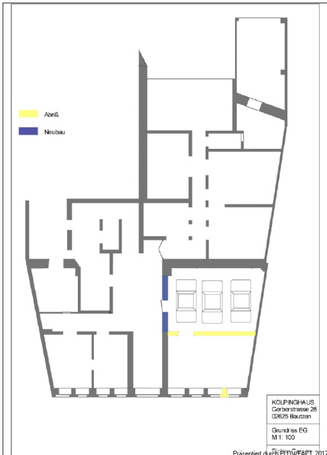
Erdgeschoß Einbau Garage
